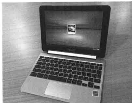
■図4:本校で採用したChromebook (ASUS Chromebook Flip C100PA)。フリップ式になっており、360度回転させるとタブレットとしても機能する
